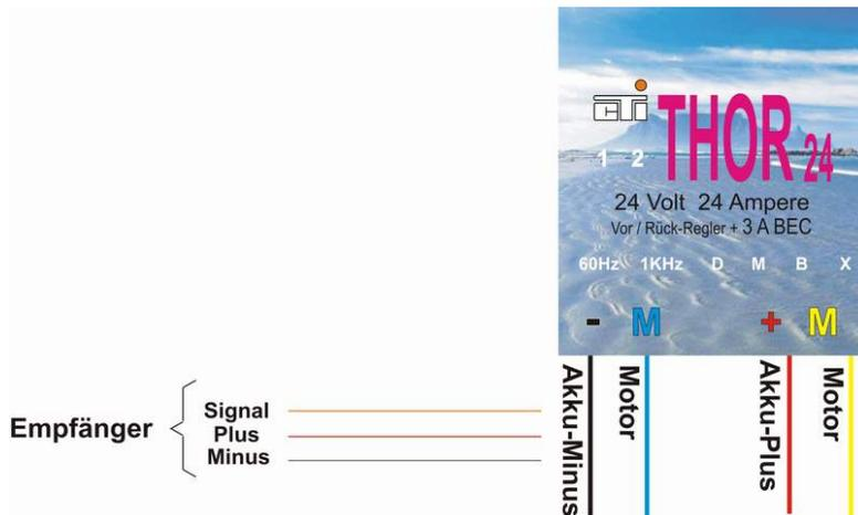
Das blaue Kabel geht zum Minuspol des Motors, das gelbe Kabel geht zum Pluspol des Motors.
